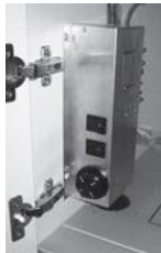
Lämpöaltaan virtakytkin ja
